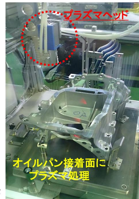
プラズマヘッドを2軸のロボットにて動作
